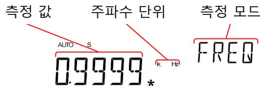
**연결**      V  $\Omega$   $\rightarrow$   $\leftarrow$  단자와 COM 단자 사이에 테스트 리드를 연결합니다. 디스플레이가 측정 값(Reading)을 업데이트 합니다.
