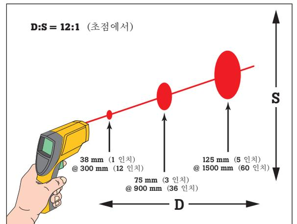
작은 물체를 측정할 때는 원하는 대상의 1.75 m 이내에서 Fluke 561을 사용하십시오. 측정 면적은 거리에 따라 증가합니다 (해당 영역 직경은 대략적으로 거리를 12로 나눈 값임).
